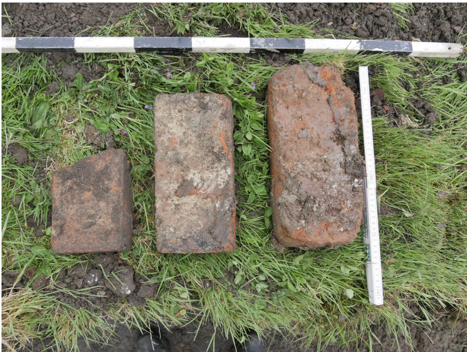
Abb.1: Freepsum. Aufgrund des Formats der Backsteine lassen sich diese datieren und damit auch die Bauphasen von Gebäuden (Foto: M. Oetken)
